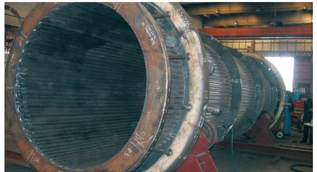
Heizflächen einer Abgasstrecke in der Fertigung
